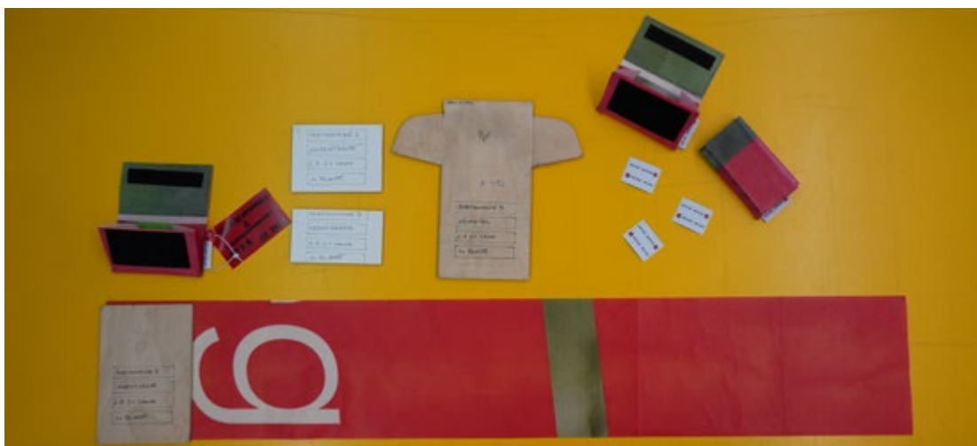
Jeder Arbeitsschritt ist sorgfältig geplant: Bevor die Arbeiten an der Nähmaschine beginnen, schneiden die Mitarbeitenden die Werbeblachen mit einem Schnittmuster aus Holz zu. Chaque étape est soigneusement préparée: avant de coudre les bâches à la machine, les collaborateurs coupent les pièces à l'aide de patrons en bois.
